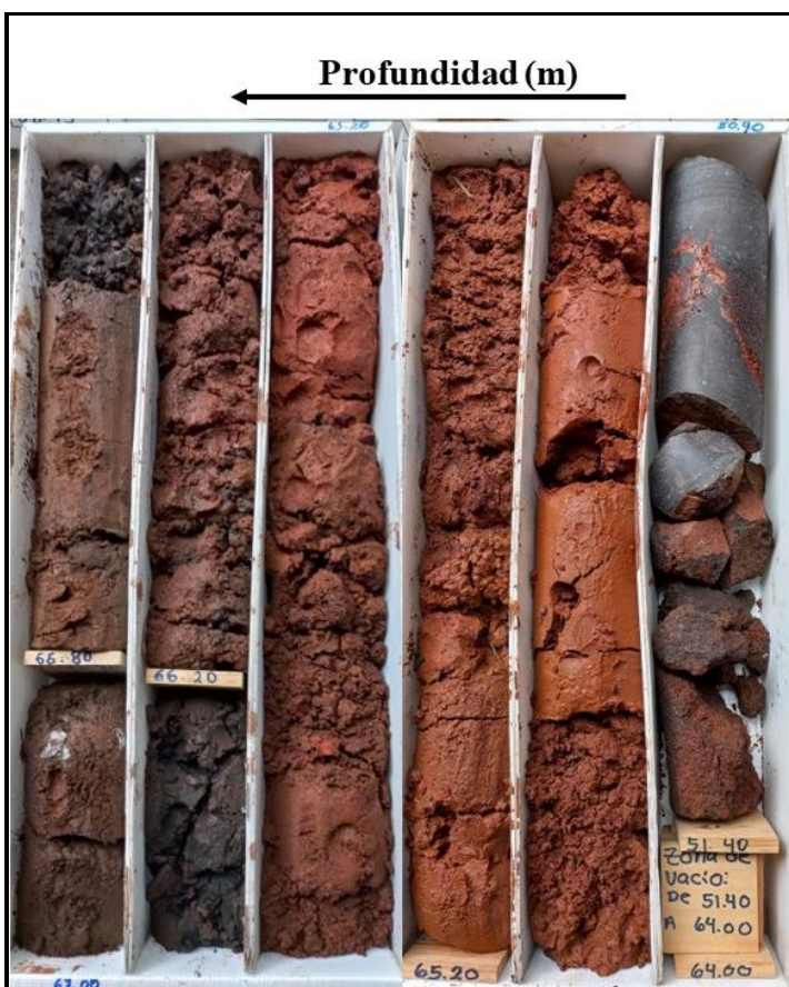
Figura 2. En la base de la lava a 51.40 m y el techo del horizonte quemado, a 64.00 m se encontró caída libre de la herramienta de perforación y también hubo pérdida total (PT) de fluidos de perforación, debido a la presencia de una cárcava, que se desconoce su tamaño y forma.
