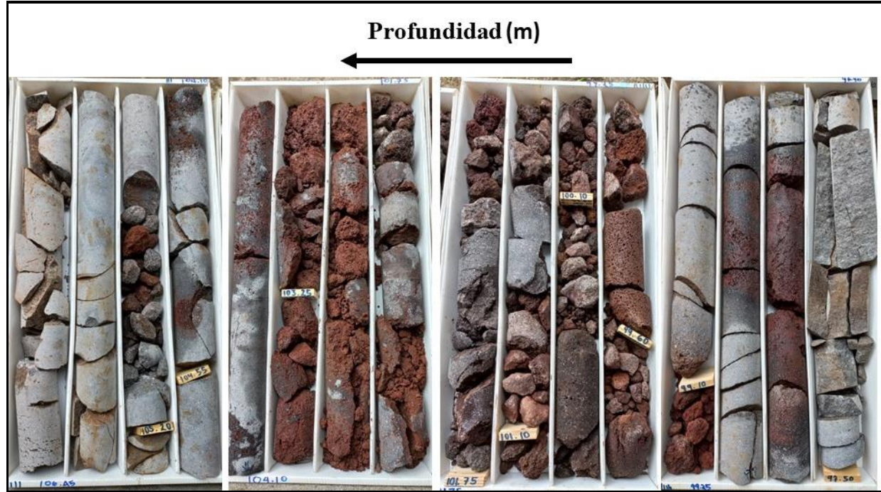
Figura 4. Segmento de lavas entre los 96.90 m y 106.45 m mostrando fracturamiento alto y también niveles de brechas escoriácea y café-rojiza, por oxidación. Toda la secuencia de lavas es altamente permeable.
